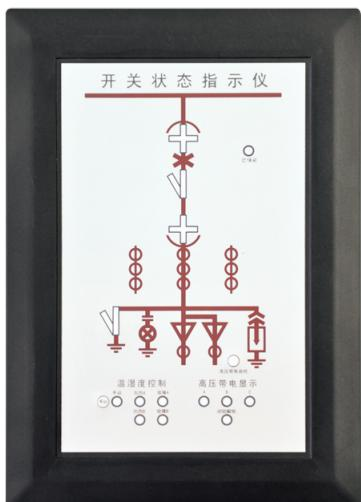
开关状态显示仪根据当前中压系统开关柜技术发展而开发的一种新型的多功能、智能化模拟动态指示装置。它集一次回路模拟图、开关状态、断路器位置、接地闸刀位置、弹簧储能状态、高压带电指示等多功能于一体，这些指示功能可分可合，用户可根据需要选择，只要提供一次方案图即可。该产品以一体化布局配套装备于开关柜，将简化开关柜的面板结构设计，美化开关柜的面板布局，完善开关状态的指示功能和安全性能。
