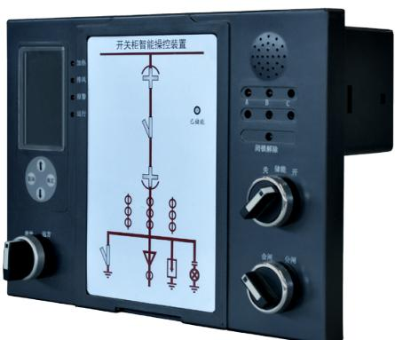
YH-200型全新概念的开关柜智能操控装置功能强大，适用于3-35KV户内开关柜，如中置柜、手车柜、固定柜、环网柜等多种开关柜。具有动态一次模拟图、高压带电显示、自动加热除湿、自动风机降温、温湿度数值显示、断路器分合状态指示、储能指示、接地开关状态指示、小车位置指示、分合闸回路完好指示、人体感应及柜内照明、超温报警、语音防误提示等功能，可取代一次回路模拟图、带电显示器、自动加热除湿控制器、断路器分合按钮等。并且具有RS485通讯接口，能够使开关柜进一步智能化、网络化、数字化，方便广大用户远程设置和监视，所有功能均可以根据用户习惯自行配制，极大地方便用户使用。
