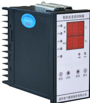
YHW02型温湿度控制仪是外型系列仪表，具有高精度、超高稳定性、操作简便等特点，温度低于下限值或者湿度高于上限值时自动启动加热器；当温度高于上限值时自动启动排风扇。从而使柜体内温度、湿度控制在允许范围内，可有效的防止柜体内温度过高、过低引起的原件失效或由于湿度过高而引起的爬电、网络事故。产品具有通讯接口，可实现远程及就地参数设置和状态监视。
