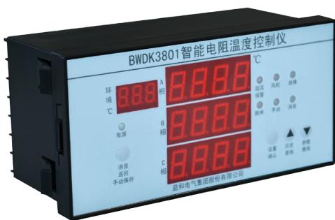
YHW3801是微处理器控制的智能仪器，它使用三~四只铂电阻作为传感器，测量干式变压器三相绕组的温度。根据设定的温度值，启停风机进行温度控制。仪器具有声光报警功能，是确保干式变压器的重要装置。仪器符合JBT-7631-2005标准。
