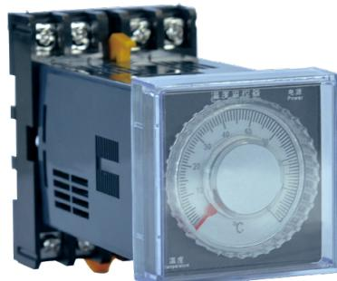
YHW-JH(TH)采用继电器控制，稳定性好，可在恶劣的环境下长期使用。该产品主要用于电力设备（如户外端子箱、高低压控制柜，手车式开关柜、环网开关柜、地下变电站、箱式变电站、断路器机构箱、仪表箱等）以及其它需自动保持一定温湿度区间的场合。能够有效防止因温湿度过低或过高而引发的各类事故，保障自动化作业的高效、安全运行。采用轨道式安装，减少开孔，使用便捷。
