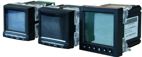
应用于电力电网自动化控制系统，主要用于测量电网中的电流和电压等参量，计算电网频率、功率因数、有功功率、无功功率等，具有电能计量等功能，并由数码管（LED）或液晶（LCD）显示当前电网中的电流和电压值等测量和计算值，而且用户可以自行设定电流和电压的变比。具有4-20MA模拟量变送输出、开关量输入输出和RS485通讯等功能。
